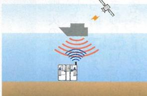
水底の堆積物を、堆積層が混ざり合うことなく採取できるのが特徴。浮沈制御、カメラ、採泥器など機能ごとに分割できる構造で、目的に応じて使うことができます。
