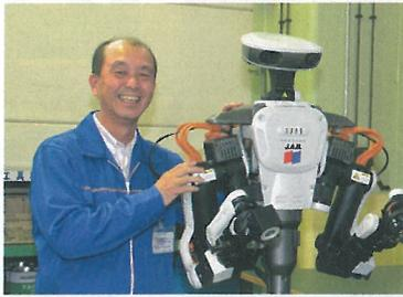
人が立ち入ることができない災害現場で活躍するロボットを開発しています。我々はロボットのハンド(手)の開発を担当しています。強く握りすぎないように、人の皮膚感覚の代わりとなる力覚センサーを開発し、卵でも風船でも、ものにに応じてつかむ強さを変えることができます。
